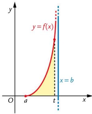
**Figura 27** Interpretazione geometrica dell'integrale di una funzione illimitata per  $x=b$ : l'integrale corrisponde al limite per  $t \rightarrow b^-$  dell'area del trapezoide colorato.
