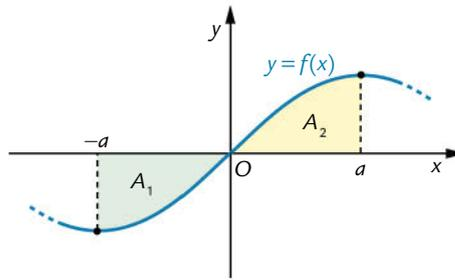
Figura 7 Integrale definito di una funzione dispari su un intervallo simmetrico rispetto all'origine.
