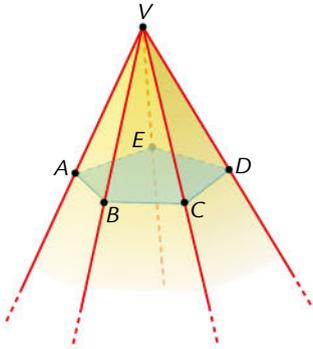
**Figura 42** Angoloide di vertice  $V$ . Le semirette  $VA$ ,  $VB$ ,  $VC$ ,  $VD$  e  $VE$  sono gli spigoli dell'angoloide. L'angolo di vertice  $V$  che ha come lati le semirette  $VA$  e  $VB$  rappresenta una delle cinque facce dell'angoloide.
