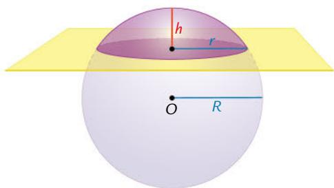
Figura 55 Segmento sferico a una base e calotta sferica.
