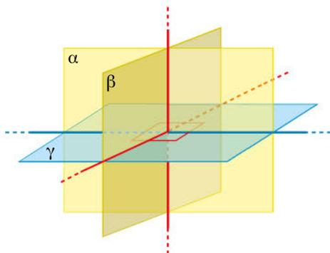
**Figura 30** I due piani  $\alpha$  e  $\beta$  sono perpendicolari; infatti le sezioni normali tramite il piano  $\gamma$  dei quattro diedri da essi formati sono angoli retti.
